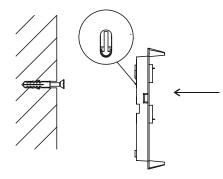
Paso 3 Empuje la base del equipo hacia bajo, que llegue hasta el fin de carrera del tornillo.
