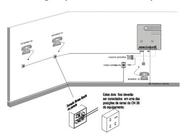
En este caso, usted tendrá que conectar el par de cables de cada interno en una toma estándar Telebras, de inmediato, enchufe los teléfonos y luego pase los cables a través de canaletas (use canaleta perfil PVC 2200x10x20) hasta el lugar donde se encuentra instalada la Central
