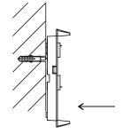
Paso 5 Retire el equipo, perfore la pared en el lugar definido y luego encaje el taco.
