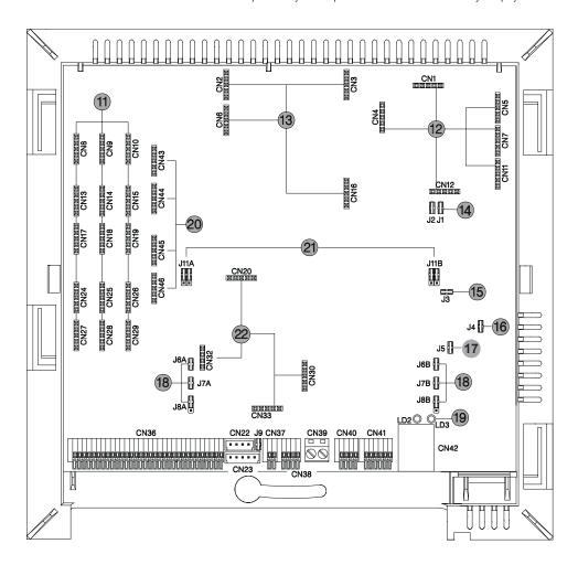
(11) Conexión para la Placa de Interno Placa 1: Internos 20 a 23 (CN8, CN13, CN17, CN24, CN27)
