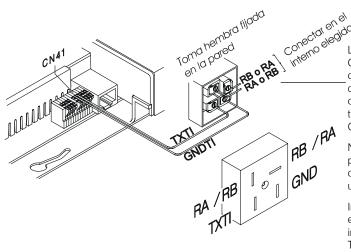
La conexión de la Terminal a la Central se hace a cuatro hilos, dos para áudio (RA/RB) y los otros dos, utilizando la Placa de Comunicación, para transmisión de datos (TXTI/GNDTI).
