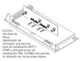
Instale la Placa Identificador de Llamadas en los conectores CN43, CN44, CN45 y CN46 de la Placa Base. Ajuste el jumper J1 (A-B)de la placa Identificador conforme las características de su línea telefónica: Jumper Abierto: líneas largas (alta sensibilidad)
