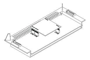
Inserte la placa de Atendedor en los conectores CN2, CN3, CN6 y CN16 de la placa base.
