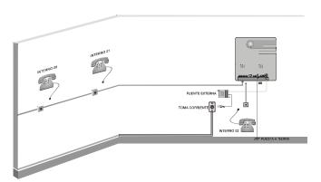
En este caso, usted tendrá que conectar el par de cables de cada interno en una toma estándar Telebras, de inmediato, enchufe los teléfonos y luego pase los cables a través de canaletas (use canaleta perfil PVC 2200x10x20) hasta el lugar donde se encuentra instalada la Central.
