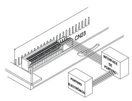
Instale la Interface de Portero en el conector CN23 de la placa base. Configure la Interface de acuerdo con las instrucciones del manual adjunto.
