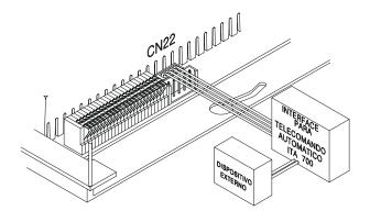
Instale la Interface para Actuación Externa en el conector CN22 de la placa base. Para el correcto funcionamiento de la Interface de Actuación Externa ITA 700, ejecute las programaciones presentadas en este capítulo.
