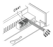
Después de la instalación de la Placa de comunicación, usted podrá instalar la interface serial conectándola directamente en el CN41 de la placa base.
