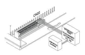
Para que la Llamada de Emergencia sea accionada por un dispositivo externo con la llave de contacto normalmente abierto, conéctelos a la Interface de Actuación Externa ITA 700 en el CN22 de la placa base e interconecte los contactos de la llave en SALMA y SALMB.
