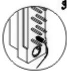
Utilizando un conector para enrollar (WIRE-WRAP) adecuado al diámetro de los pines de los conectores de las líneas, efectúe la instalación del cableado como se aprecia en la ilustración:
