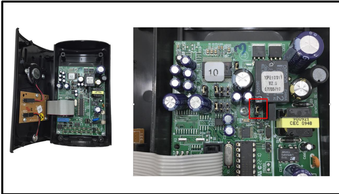
Figura 2 – Configuração de jumper, CN 7 posições 2 e 3
