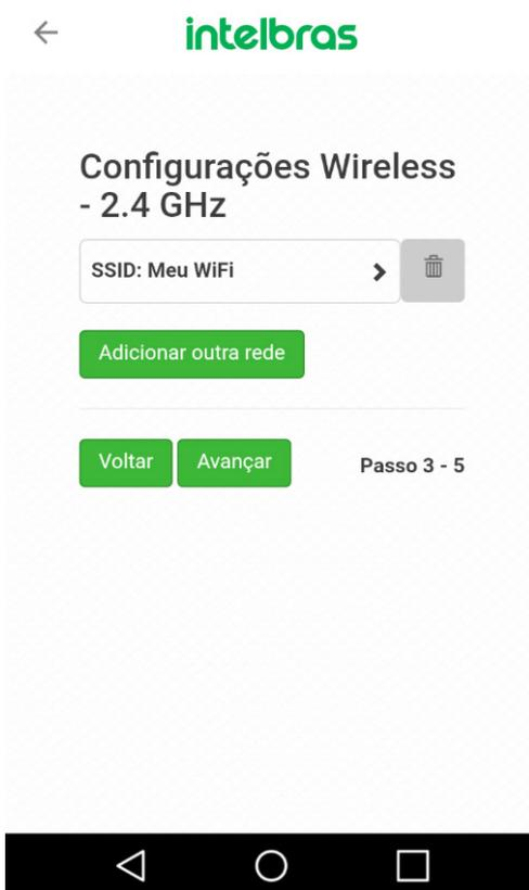
5. Neste passo você irá configurar as redes Wi-Fi do seu roteador. Para adicionar mais redes Wi-Fi, clique no botão *Adicionar outra rede* e para alterar as configurações de uma delas, clique sobre a seta que fica ao lado do nome da rede, para que a tela a seguir seja exibida;
