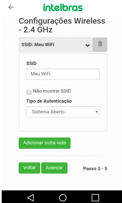
6. No campo *SSID*, escolha um nome para a sua rede sem fio e no campo *Tipo de autenticação*, configure como deseja que os seus clientes se conectem na rede, na imagem acima, por exemplo, configurando o tipo de autenticação como *Sistema aberto*, não será solicitada senha de acesso à rede sem fio. Caso queira configurar a sua rede Wi-Fi com senha, siga o exemplo da imagem a seguir:
