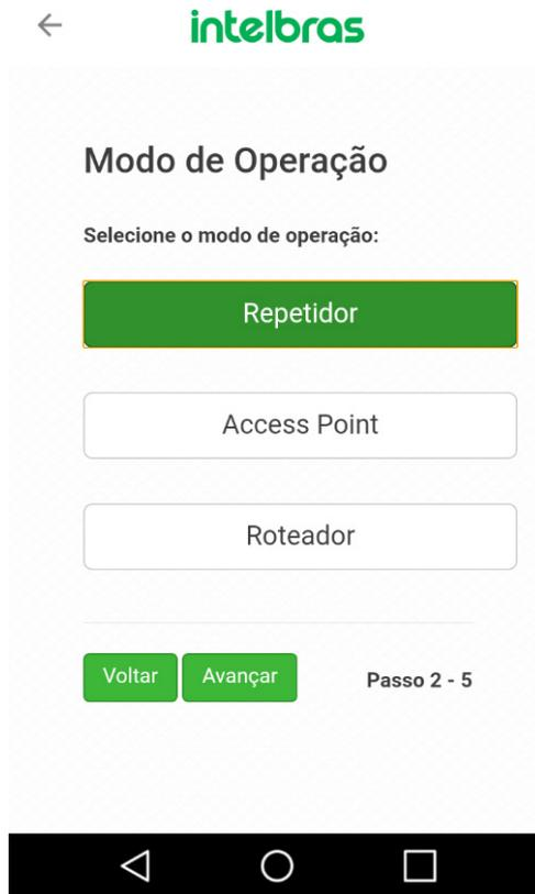
4. Assim como a imagem acima, escolha a opção *Repetidor* e clique em *Avançar* para seguir aos próximos passos da configuração;
