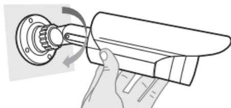
5. Se houver necessidade de ajustar a rotação, solte o anel de pressão da base do suporte e gire o suporte para a direção desejada. Após ajustar a posição da câmera na horizontal aperte o anel de pressão do suporte;
