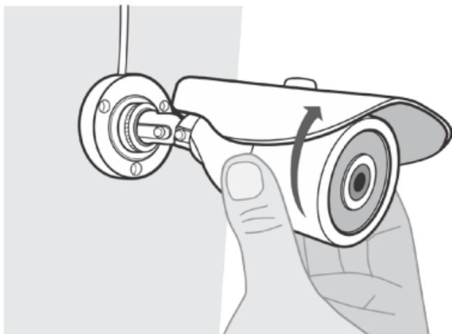
5. Para ajustar o campo de visão da câmera, primeiro solte o anel de pressão da base do suporte e gire a câmera para a direção desejada. Aperte o anel da base do suporte após realizar esse ajuste;
