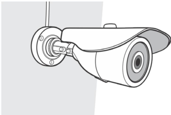
4. Para ajustar a inclinação da imagem, solte o parafuso que prende o suporte ao gabinete e gire a câmera até que a imagem fique alinhada. Aperte o parafuso que prende o suporte ao gabinete após realizar este ajuste;
