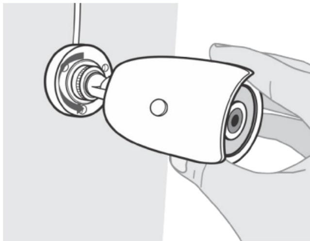
6. Para ajustar a direção da câmera, solte o parafuso da articulação central do suporte e movimente o gabinete para a direção desejada. Aperte o parafuso da articulação central após realizar esse ajuste.
