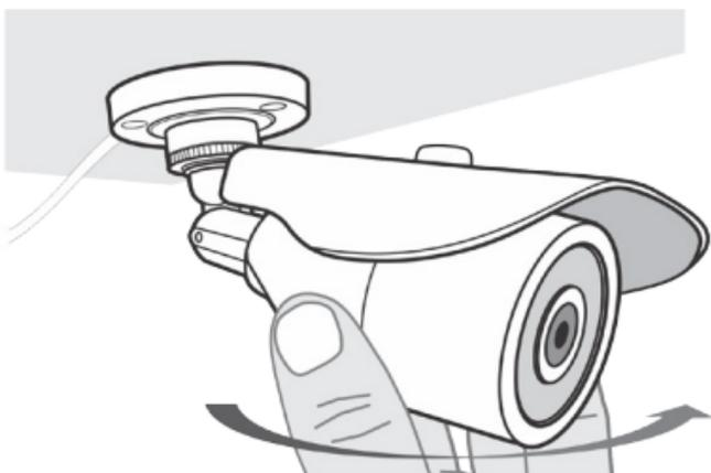
6. Caso haja necessidade de corrigir a inclinação da imagem, solte o parafuso que prende o suporte ao gabinete e gire-o até que a imagem fique alinhada no monitor. Após ajustar a inclinação da imagem, aperte o parafuso que prende o suporte à câmera.
