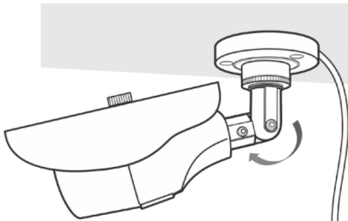
5. Se houver necessidade de ajustar a posição na horizontal, solte o anel de pressão da base do suporte e gire o suporte para a direção desejada. Após ajustar a posição da câmera na horizontal aperte o anel de pressão do suporte;
