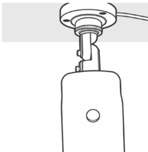
4. Para ajustar o campo de visão da câmera, primeiro solte o parafuso da articulação central do suporte. Após ajustar a posição da câmera na vertical aperte o parafuso da articulação central;
