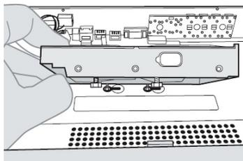
5. Vire o NVR e aperte os parafusos firmemente;
