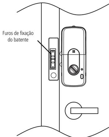
15. Faça as furações e parafuse o batente no local marcado (utilize quatro parafusos A M4 x 25);
