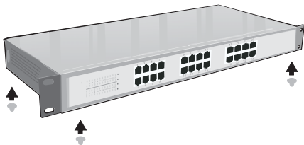
Figura 4 - Instalação dos pés de borracha
