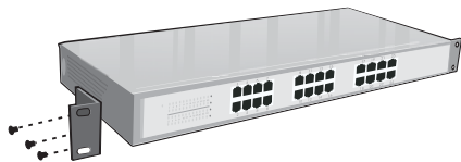
Figura 2 - Fixação dos suportes em "L"
