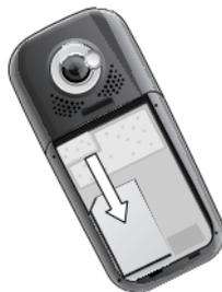
Localize o encaixe do cartão SIM atrás do telefone e deslize-o para inserir. Durante a instalação, certifique-se de que os contatos metálicos do chip estejam voltados para baixo.
