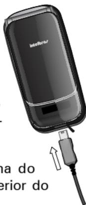
1. Remova o protetor de borracha do conector localizado na parte inferior do telefone;
