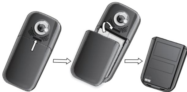
**Obs.:** Desligue o telefone para remover a bateria. Todas as configurações ou informações armazenadas no cartão SIM e no telefone podem ser perdidas ao remover a bateria com o telefone ligado.
