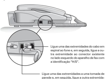
de ao conector existente no lado esquerdo do aparelho de fax com a identificação "LINE".
