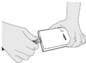
Conexão do cabo ao repetidor GSM
