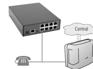
Conexão da linha telefônica e do aparelho telefônico em paralelo
