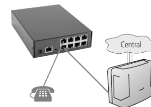
Conexão da linha telefônica e do aparelho telefônico em série
