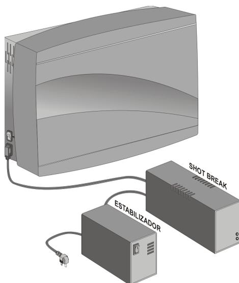
Em locais sujeitos a transientes elétricos ou descargas atmosféricas para proteção dos equipamentos deverá ser instalado protetores contra transientes na entrada AC.
