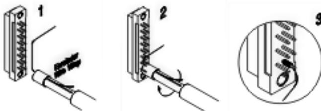
No XPE 1001 T, conecte os fios de ramal da central no conector CN 4, nas posições RA/RB:
