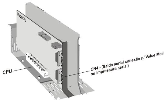
Para instalar uma Impressora Serial, o conector CN4 da Placa CPU faz a conexão serial obedecendo o diagrama.
