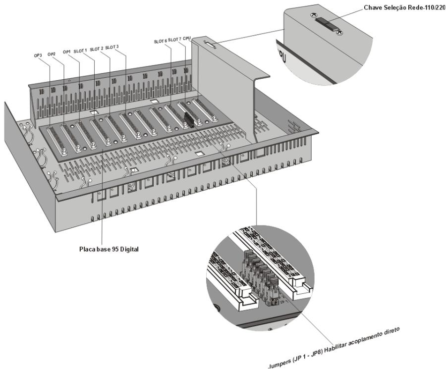
A Central 95 Digital possui posições de placas (slots) que podem suportar mais de um tipo de placa:
