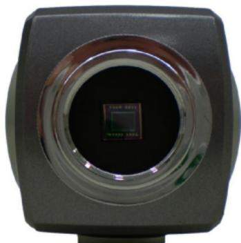
Afrouxe o parafuso localizado na parte inferior do anel para des-travar o mesmo e regular a distância entre o CCD e a lente, isto possibilita um melhor ajuste do foco. Esse anel também pode ser utilizado juntamente com o adaptador para lentes do padrão C.
