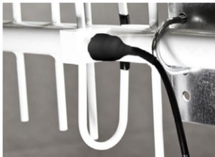
Conexão do cabo de descida
