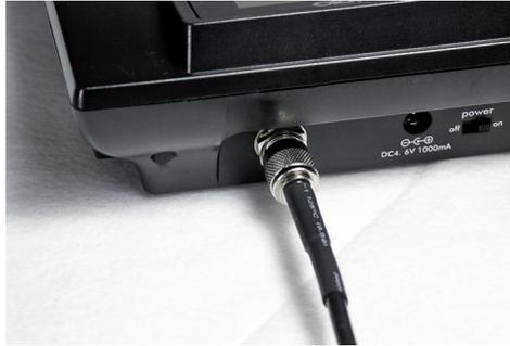
**Atención:** cuide para que el cable coaxial no sufra deformaciones, compresiones, tracciones, giros o cortes. No doble el cable, cuanto más recto esté el cable, mejor será la calidad de señal.
