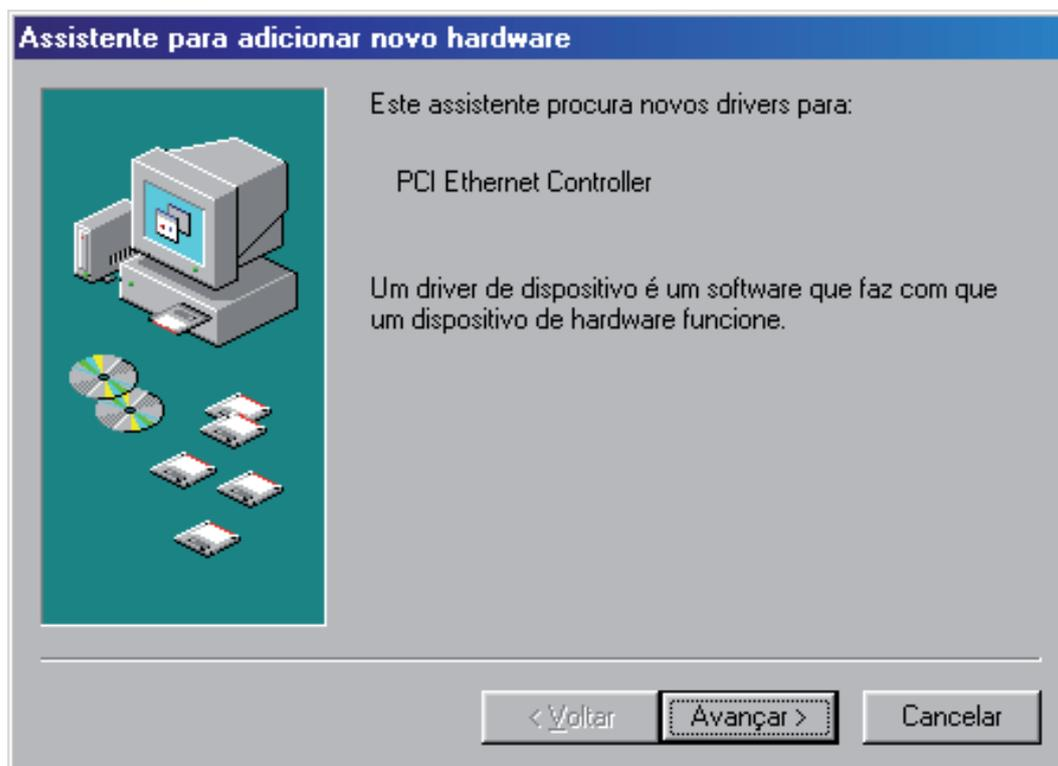
2. Insira o CD de instalação fornecido com a placa na sua unidade de CD-ROM e aguarde o início automático da instalação do *Assistente Wireless Intelbras WPS200E*, conforme a figura a seguir. Caso a instalação não inicie automaticamente, abra o *Explorer* do Windows®, clique na unidade correspondente ao CD-ROM, execute com um duplo clique o programa *WPS200E\_Setup\_98ME.exe* e siga as instruções de instalação do Assistente até a conclusão do processo.
