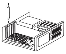
Insira a WPG 200 no slot PCI fixando-a ao gabinete do computador. Dependendo do modelo do gabinete de seu microcomputador, pode ser necessário utilizar um parafuso (UNC 6-32) para a correta fixação.
