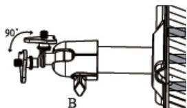
3. Insira a câmera ao suporte, parafusando-a no sentido horário até que esteja firme. Ajuste a câmera para a posição de exibição desejada (C), em seguida, aperte o parafuso de ajuste de posicionamento (B);
