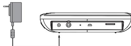
3. Pressione o botão Liga/Desliga e mantenha-o pressionado durante 1 segundo. Para desligar o monitor, pressione o mesmo botão e mantenha-o pressionado durante 2 segundos;
