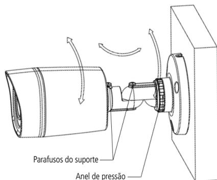
5. Após ajustar a posição da câmera, aperte os parafusos para que o ângulo da imagem se mantenha fixo.
