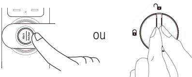
Abrindo a porta pelo lado de dentro
