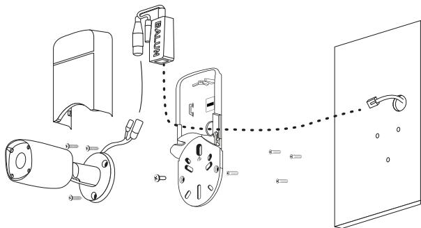
2. Caso o cabo venha através de tubulação/canaleta sobre a superfície, posicione-o pelas laterais da caixa, conforme ilustração:
