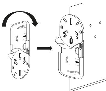
4. Reposite a caixa e finalize a fixação à superfície com a câmera, utilizando os parafusos do kit de instalação da câmera.
