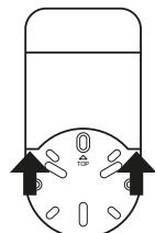
2. Fixe a caixa na superfície de instalação com o parafuso e bucha do kit de acessórios.
