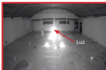
Luz IR contra a câmera afetando a qualidade da imagem e da detecção
