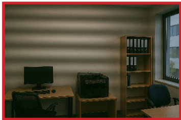
Sem o Anti-Flicker pode-se perceber faixas visíveis causadas pela cintilação da iluminação
