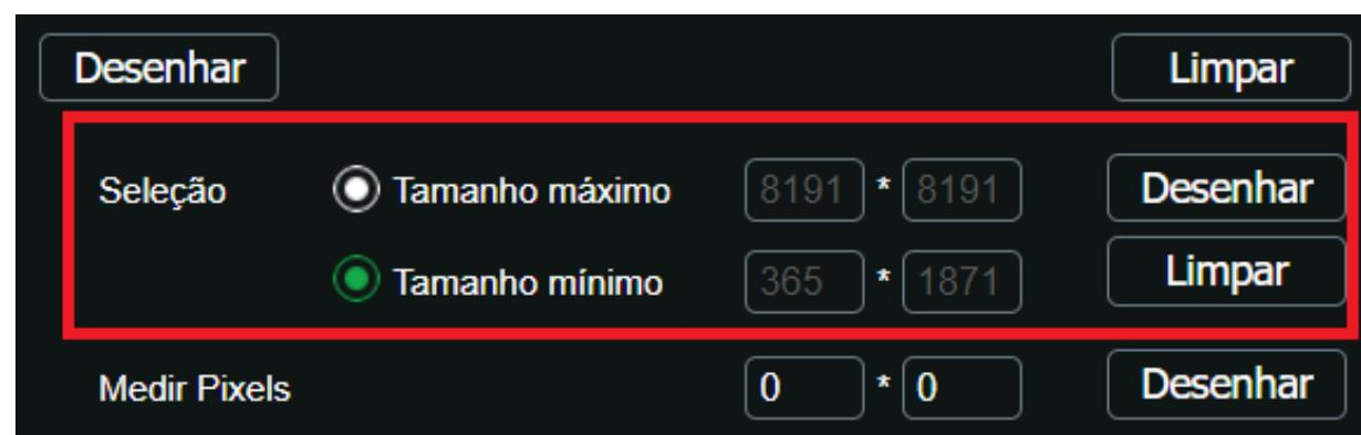
A função **Medir Pixels**, permite ao usuário quantificar os pixels horizontais e verticais de uma área. A aplicação é verificar se a quantidade de pixels dentro dessa área é o suficiente para gerar uma imagem nítida, por exemplo permitir o usuário reconhecer detalhes do alvo.
