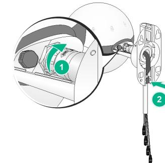
Então, use um cabo ethernet para conectar a porta ethernet em um switch ou injetor PoE à porta de Uplink/PoE do cabo conectado ao AP.
