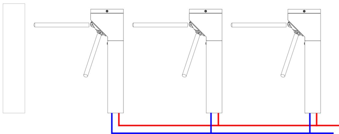
A passagem dos cabos deve ser realizada através das aberturas localizadas na parte inferior das catracas, conforme ilustrado na imagem acima. Para isso, é necessária a utilização de duas vias de eletroduto: uma destinada à fiação de alimentação, identificada em vermelho no diagrama, e outra para os cabos de dados, identificada em azul.
