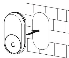
Instalação usando fita dupla face (não precisa abrir a tampa neste caso)
