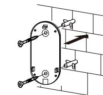
Instalação usando parafusos
