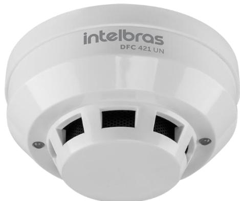
O detector de fumaça convencional foi projetado para disparar em caso de detecção de fumaça no ambiente onde está instalado. Opera em sistemas de 12 e 24 Vdc e pode ser instalado por consumo de corrente ou por contato seco. O produto DFC 421 é constituído por um emissor e receptor infravermelho, que utiliza o efeito Tyndall como mecanismo de detecção
