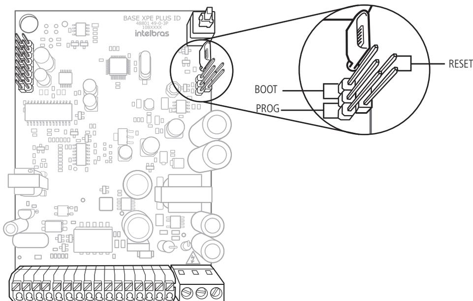
» **PROG1 e RESET:** utilizados na operação de Reset de senha geral, conforme tabela a seguir.
