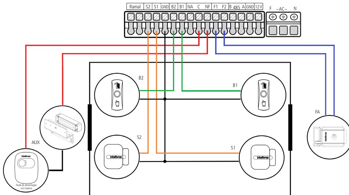
O diodo enviado junto ao kit de instalação, deve ser ligado em paralelo com a fechadura eletroímã instalada na saída de contato seco, ele tem a função de eliminar os picos de tensão gerados pela fechadura que ocorre no momento da desmagnetização. Deve-se respeitar a polaridade, ligando o catodo (tarja branca) no lado positivo da alimentação da fechadura.
