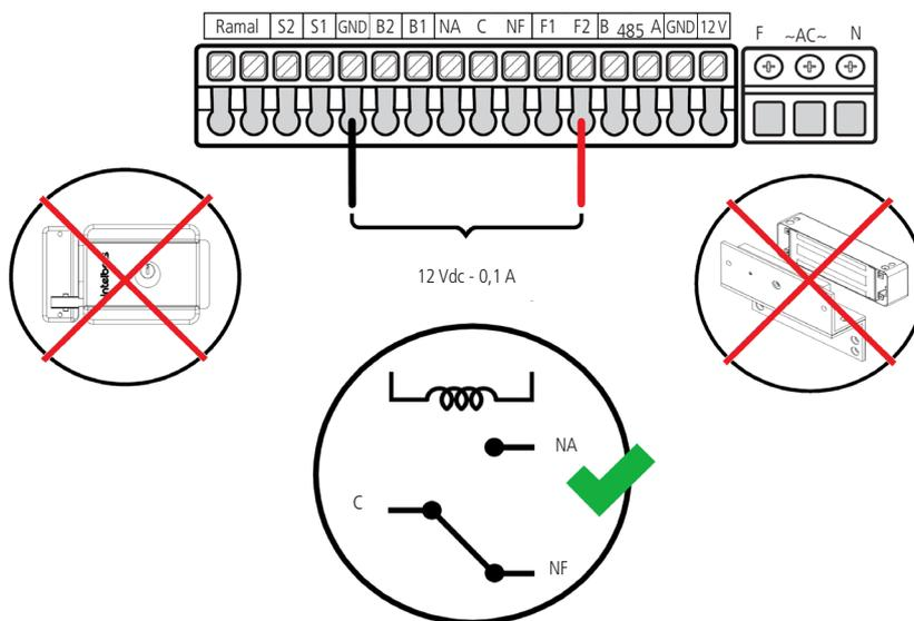
Especificação do funcionamento do XPE quando deve operar junto a um elevador, com as suas conexões de tecla de portaria, auto falante e microfone direto na placa base do interfone.
