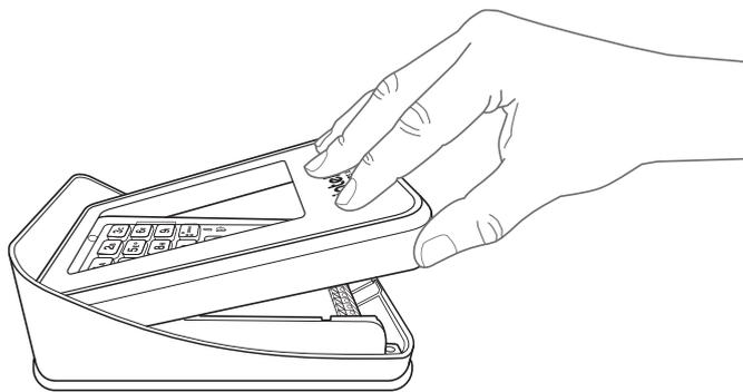
**Importante:** após a instalação, não coloque nenhum obstáculo que evite a aproximação da TAG na área de detecção, pois isto afetará a sensibilidade de leitura do equipamento.
