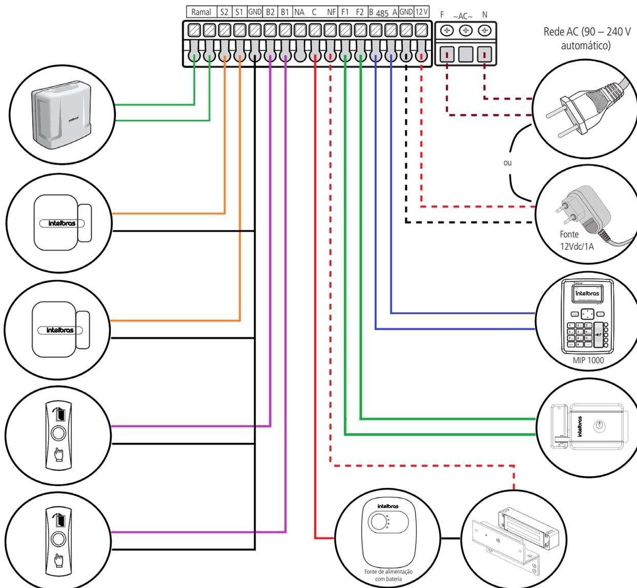
**Obs.:** o diodo enviado junto ao kit de instalação, deve ser ligado em paralelo com a fechadura eletroímã instalada na saída de contato seco, ele tem a função de eliminar os picos de tensão gerados pela fechadura que ocorre no momento da desmagnetização. Deve-se respeitar a polaridade, ligando o catodo (tarja branca) no lado positivo da alimentação da fechadura.
