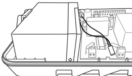
» Conecte o cabo da bateria no conector J6 da placa.
