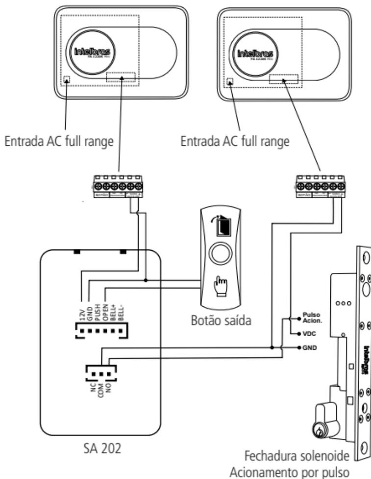
*Ligação da fechadura solenoide com pulso de acionamento*
