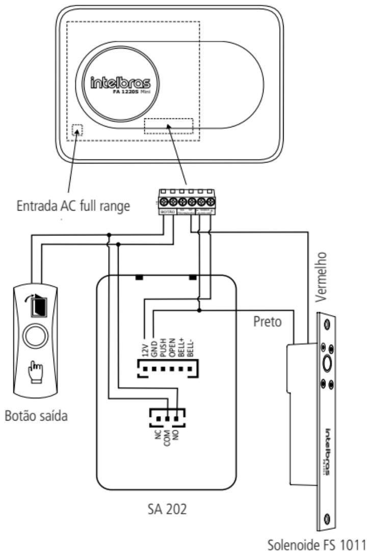
*Ligação da fechadura solenoide sem pulso de acionamento*
