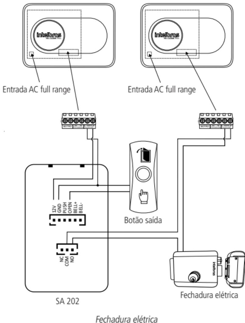
**Obs.:** a corrente nominal de chaveamento para acionar as fechaduras nas saídas NC, COM e NO é de 1,5 A.
