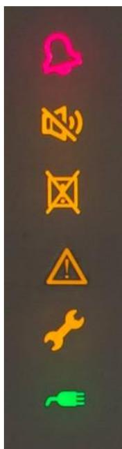
**VERMELHO:** Indicador LED de alarme de incêndio. Evento de alarme de incêndio ativo
