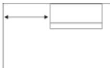
Além disso, se a parede central tiver de ser instalada na parede ao lado de uma parede de canto, a distância mínima desta deve ser de, pelo menos, 200 mm, de modo a não impedir a abertura do painel frontal.
