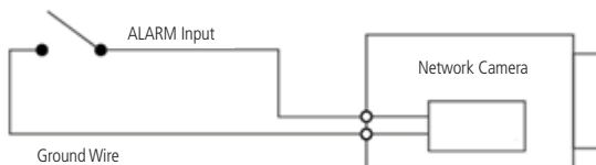
Esquema de entrada de alarme VIP 5550 Z IA
