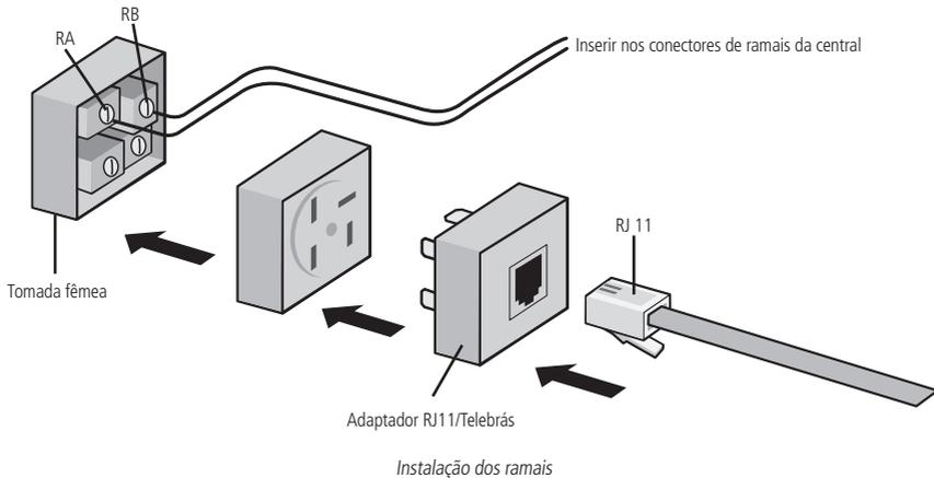
Em seguida, identifique o fio de cada um dos ramais, decape-o, pressione a alavanca do conector correspondente e insira os fios, conforme a figura a seguir:
