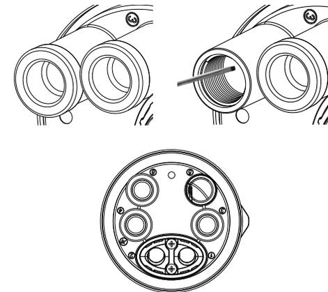
Insira o pressionador de borracha no cabo previamente preparado. Selecione a borracha de acordo com o diâmetro do cabo que será utilizado na derivação e, com o auxílio de uma chave Philips, rompa a película da borracha. Na sequência, insira o cabo.
