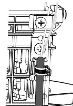
Pressione a borracha dentro da entrada de derivação até que seja possível rosquear o pressionador da borracha. Para finalizar o aperto utilize a chave de boca 30 mm, presente no kit de instalação do produto. O pressionador deve ser rosqueado até o final do canal.
