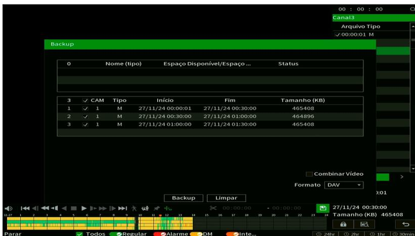
3. Escolha o dispositivo no qual deseja armazenar os arquivos: HD ou USB (necessário um dispositivo USB, formatado em FAT32, conectado ao NVR).
