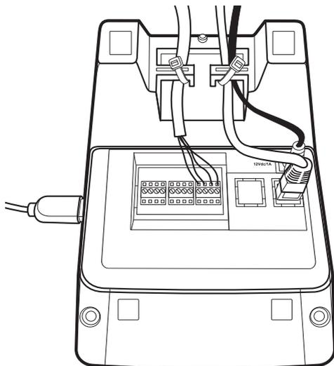
4. Encaixe o conector Jack da fonte externa (12 Vdc / 1 A) no local indicado da parte posterior do MIP IP.
