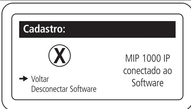
Ao selecionar *Desconectar software* O MIP 1000 IP irá fechar as conexões com o software e permitirá o cadastro via Menu. Ao finalizar as operações e voltar para a tela inicial, o MIP 1000 IP permitirá conectar ao software novamente.
