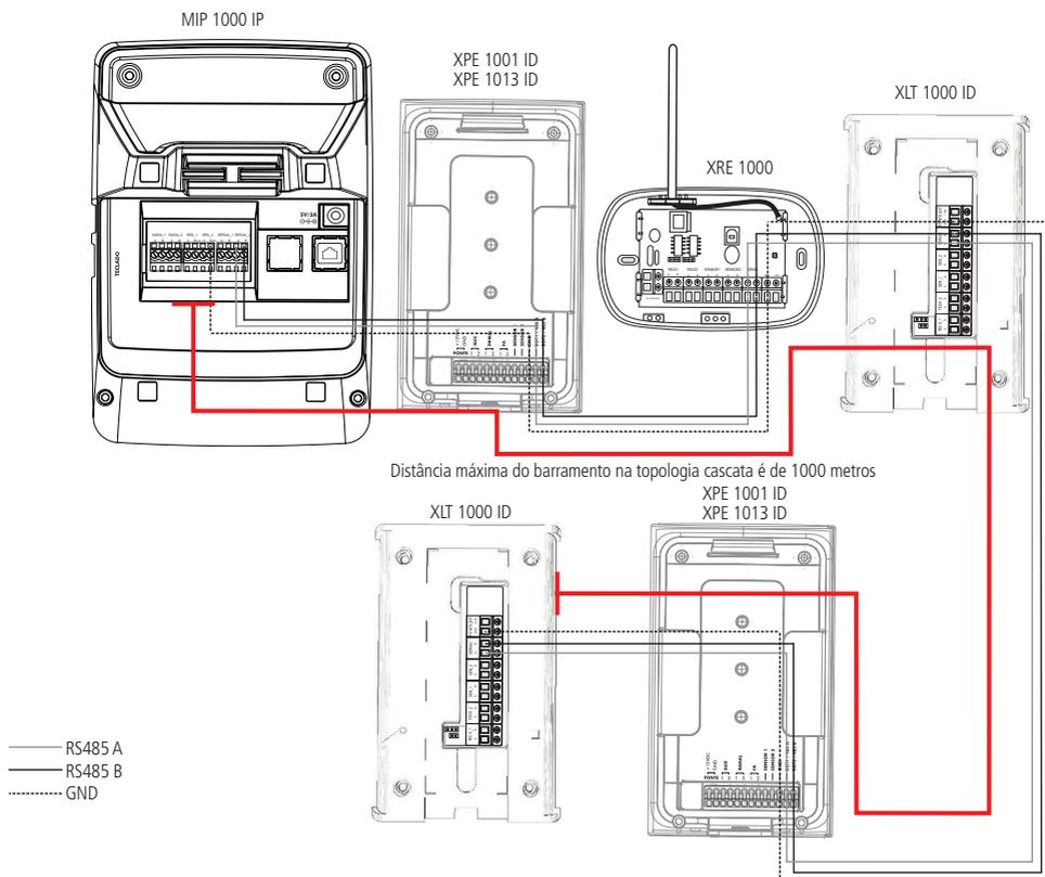
**Obs.:** utilizando a topologia cascata, este dispositivo pode ser ligado a uma distância de até 1.000 metros do MIP IP ou em cabeamento que não ultrapasse 250 ohms, desde que utilizados cabos de boa qualidade, como informado na recomendação 9 do item 4.1 Barramento de comunicação.
