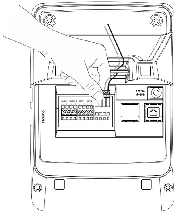
3. Após o encaixe no conector macho do MIP IP realizar a passagem e acomodação dos cabos no local de passagem de cabos.
