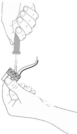
2. Após parafusar os cabos, encaixe o conector fêmea no conector macho do MIP IP;
