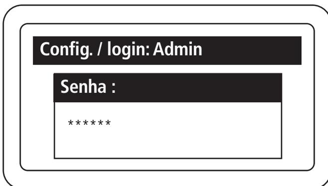
A senha padrão de fábrica e 123456 para alterar basta apagar e digitar a nova senha desejada e pressionar *Enter* (usar no mínimo de 1 a 6 caracteres).
