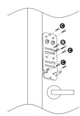
Importante: remova os contra parafusos ao instalar em portas com espessura inferior a 35 mm ou ao utilizar calcos
