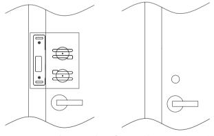
Importante: antes de montar o produto, verifique se os acabamentos e/ou vista/guarnição da porta prejudicam a instalação. Pegue a unidade interna e projete a lingueta utilizando a manopla. Coloque-a sobre o local de instalação, juntamente com o batente, conforme a imagem a sequir:
