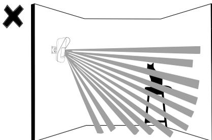
**Obs.:** antes de iniciar a instalação, é necessário definir a altura em que o sensor será posicionado, que pode variar de 2 a 2,2 m. Se o sensor for instalado a uma altura inferior a 2,0 m ou for inclinado para baixo, a função *Pet* será comprometida.
