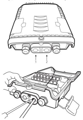
5. Coloque e aperte a abraçadeira metálica no interior da caixa:
