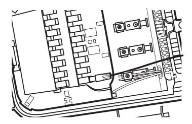
2. Acomode o cabo drop nos adaptadores indicados pelas posições de 1 a 16 na bandeja, conforme a figura abaixo:
