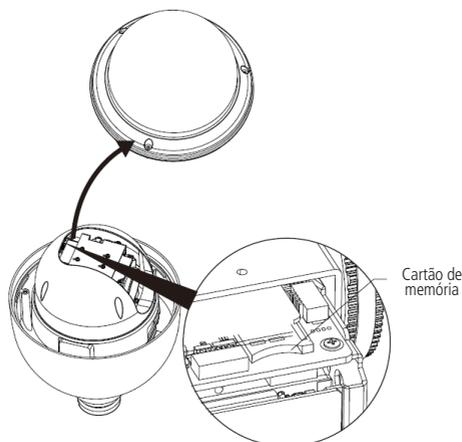
2. Feche a cúpula da câmera, certificando-se de que os 4 parafusos estejam apertados e que a cúpula esteja bem encaixada.
