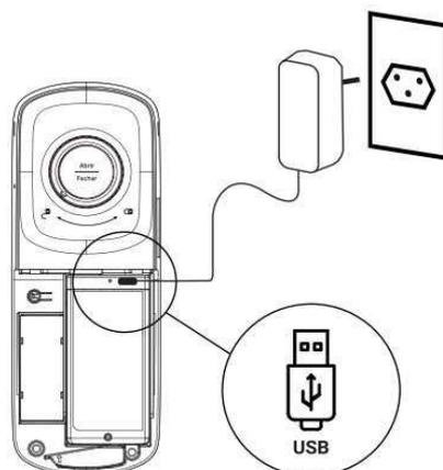
**Atenção:** ao remover a bateria, sua fechadura ficará inoperante. Após realizar a carga completa, retorne imediatamente a bateria à fechadura. Ao encaixá-la, pressione até ouvir o clique.
