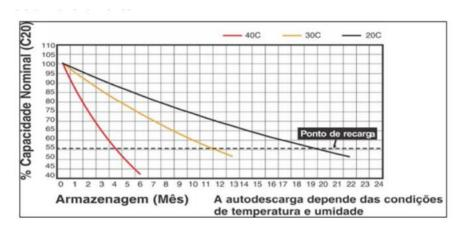
Baterias não devem ser armazenadas por mais de 180 dias sem receber uma carga de manutenção ainda que a temperatura de armazenagem seja de 20°C ou a tensão não esteja abaixo 12,40V.
