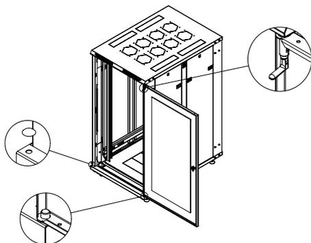
Com o conjunto de dobradiça, pino pivotado e pino nivelador fixados, alinhe a porta e encaixe nos locais indicados.
