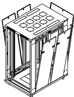
Para a inserção dos quatro fechamentos laterais e do fechamento posterior na estrutura, é necessário seguir o posicionamento descrito na imagem. Após os fechamentos estarem fixados na base por meio do encaixe, empurrar a parte superior até que os fechos deslizantes cliquem.
