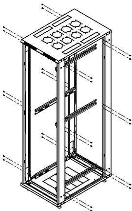
Após a estrutura preliminar estar orientada conforme imagem, insira os perfis horizontais nos locais indicados com os parafusos.
