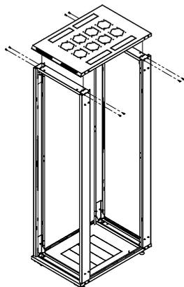
Posicione o fechamento superior (Teto) sobre as moldura conforme imagem. Insira os parafusos nos locais indicados.
