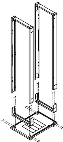
Posicione as molduras estruturais sobre o fechamento inferior (Base) conforme imagem. Insira os parafusos nos locais indicados.
