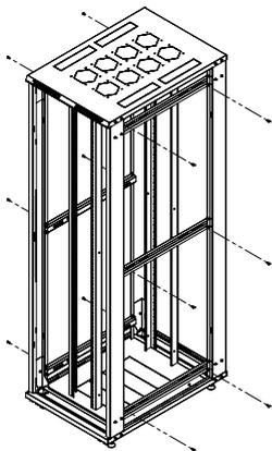
Partindo da fixação completa dos perfis horizontais, insira e fixe conforme a imagem os perfis verticais, por meio de parafusos nos locais indicados.
