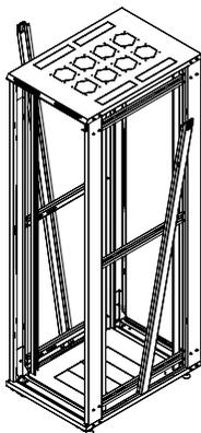
Para a inserção da coluna lateral na estrutura, é necessário seguir o posicionamento descrito na imagem. Após a coluna estar fixada na base por meio do encaixe, empurrar a parte superior até que os fechos deslizantes cliquem.
