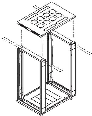
Posicione o fechamento superior (Teto) sobre as molduras conforme imagem. Insira os parafusos nos locais indicados.
