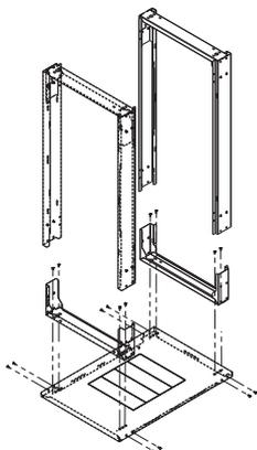
Posicione as molduras estruturais sobre o fechamento inferior (Base) conforme imagem. Insira os parafusos nos locais indicados.
