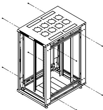
Partindo da fixação completa dos perfis horizontais, insira e fixe conforme a imagem os perfis verticais, por meio de parafusos nos locais indicados.
