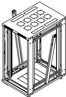
Para a inserção da coluna lateral na estrutura, é necessário seguir o posicionamento descrito na imagem. Após a coluna estar fixada na base por meio do encaixe, empurrar a parte superior até que os fechos deslizantes cliquem.
