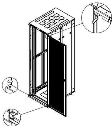
Com o conjunto de dobradiça, pino pivotado e pino nivelador fixados, alinhe a porta e encaixe nos locais indicados.
