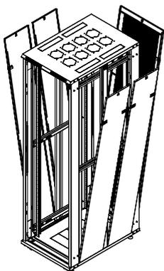
Para a inserção dos quatro fechamentos laterais e do fechamento posterior na estrutura, é necessário seguir o posicionamento descrito na imagem. Após os fechamentos estarem fixados na base por meio do encaixe, empurrar a parte superior até que os fechos deslizantes cliquem.
