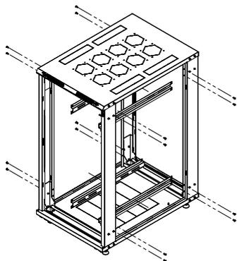
Após a estrutura preliminar estar orientada conforme imagem, insira os perfis horizontais nos locais indicados com os parafusos.
