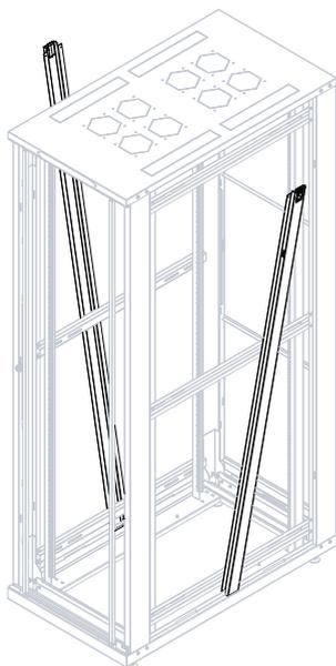
Para a inserção da coluna lateral na estrutura, é necessário seguir o posicionamento descrito na imagem. Após a coluna estar fixada na base por meio do encaixe, empurrar a parte superior até que os fechos deslizantes cliquem.
