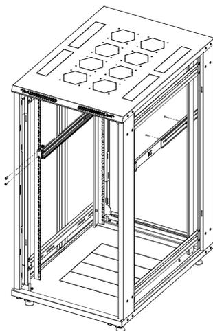
» **Passo 02:** encaixe o trilho até final de forma que cliquem conforme mostra a imagem.
