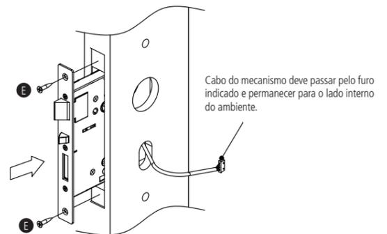
**Importante:** ao encaixar o mecanismo na porta, certifique-se que o cabo não sofrerá nenhum tipo de dano. Não faça a instalação caso notar qualquer dano no cabo do mecanismo! Nesta situação, procure uma assistência técnica autorizada.
