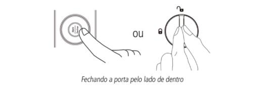
Com a função *Travamento automático* ativada, o travamento ocorrerá automaticamente em até 2 segundos após o fechamento da porta.
